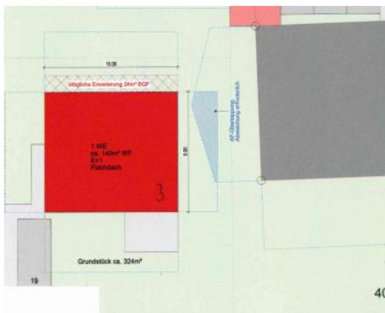
Abb. 5 Darstellung der Abstandsflächen des südlichen Neubaus und des Bestandsgebäudes auf Fl.Nr. 409, tekture Ingenieurbüro Robert Spitzhirm, Poing 2023, ohne Maßstab
