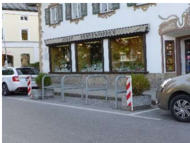
Umnutzung eines Kfz-Stellplatzes zu 6 - 10 Fahrradstellplätzen
